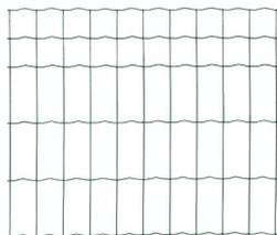
Rede electrosoldada e plastificada a verde por electrostático, malha **100x50mm**, arame de espessura exterior de 2.1mm ou 2.5mm. Rolos de 25m de comprimento com alturas de 0.6m; 0.8m; 1.0m; 1.2m; 1.5m; 1.8m e 2.0m. Acabamento superior e inferior da rede com 2 malhas de reforço 50X50mm. Postes e acessórios disponíveis.
