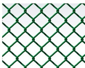
Rede elástica ou de malha solta, de simples torção, plastificada por extrusão a verde, em rolos de 25m de comprimento e alturas de 0.5m; 0.75m; 1.0m; 1.25m; 1.5m; 1.75m e 2.0m. Malha de **50mm** com arame interior de 1.8mm e exterior de 2.8mm. Galvanizada, outras cores, malhas, espessuras e alturas por encomenda. Postes e acessórios disponíveis.
