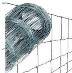
Rede vedação de malha progressiva galvanizada com nó em espiral, na série ligeira (arames de 1.9/2.4mm); série forte (arames de 2.4/3.0mm); série super-forte (arames de 3.0/3.6mm). Alturas de 1.0m (100/8/15); 1.2m (124/9/15); 1.4m (140/11/15) e 2.0m (200/20/15), em rolos de comprimento de 50m. Outros modelos, malhas e alturas por consulta.
